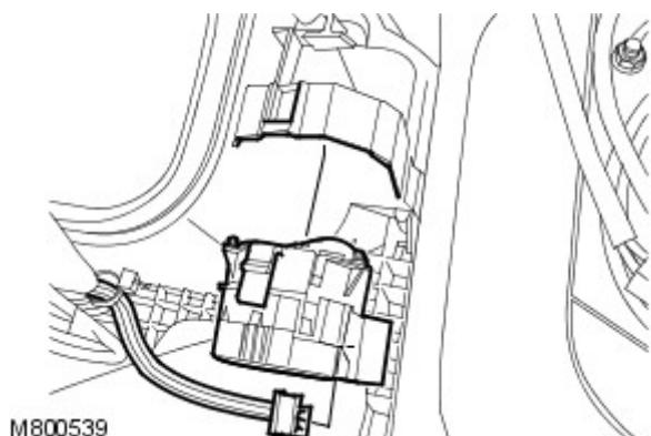
9. 卸下循环混合风门执行器。
